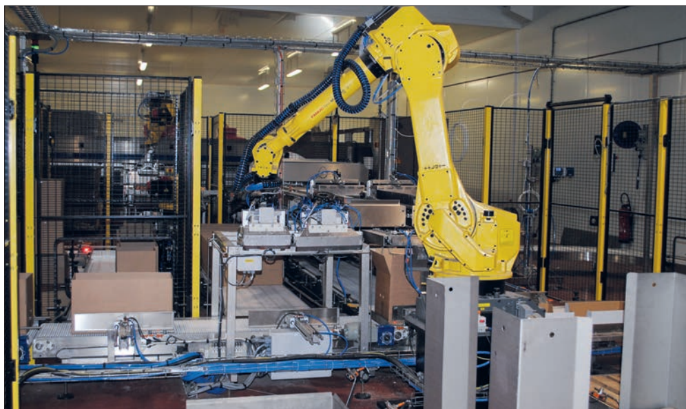
▲ Le robot effectue ici un changement de préhenseur.
